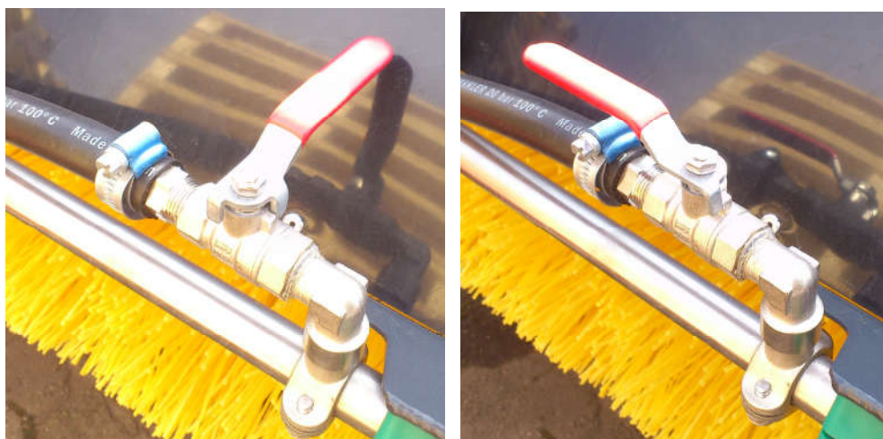
Figur 5. Kulventilen i stängt (t v) och öppet (t h) läge
