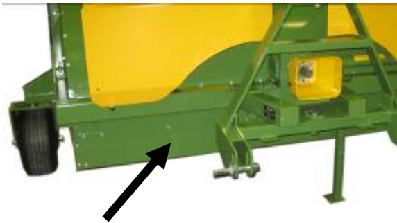
Framplåten i nedre position
