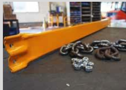
Kedjan till bottenmattan kan tas av för enkelt underhåll
